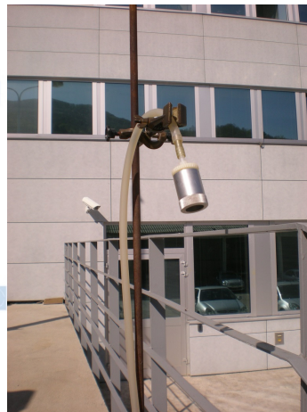
Črpanje skozi celulozni filter
